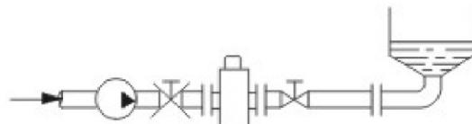
e. 不能在泵抽吸侧安装流量计。
